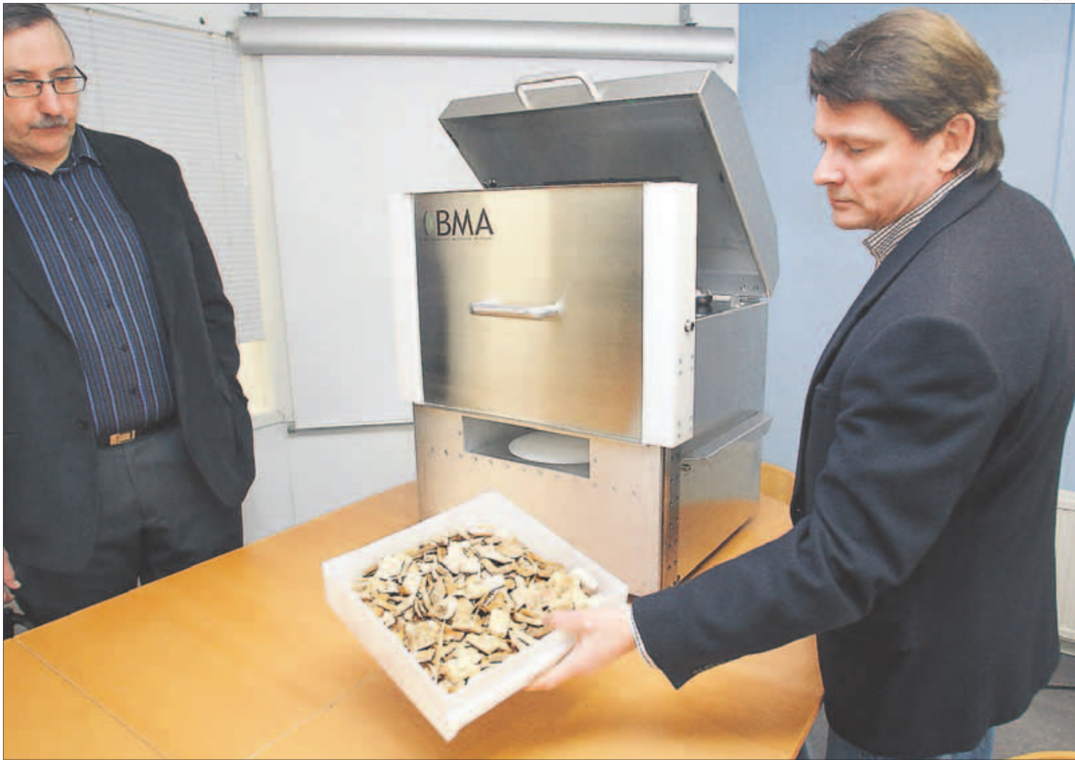
– Hake tai muu biomateriaalinäyte asetetaan kaukolassa laitteen alaosassa olevaan mittakammioon. Kosteusprosentti selviää muutamassa sekunnissa, Senfit Oy:n toimitusjohtaja Markku Korhonen (oi-kealla) ja teknologiajohtaja Pekka Jakkula kertovat.
